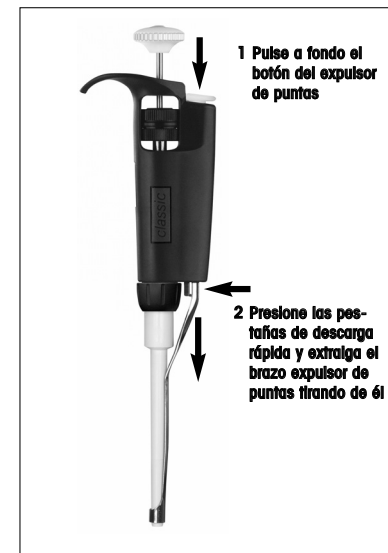
Figura 3 Retirada del brazo expulsor de puntas
